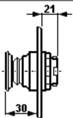
Face avant de bouton-coup de poing- ARRET D'URGENCE
